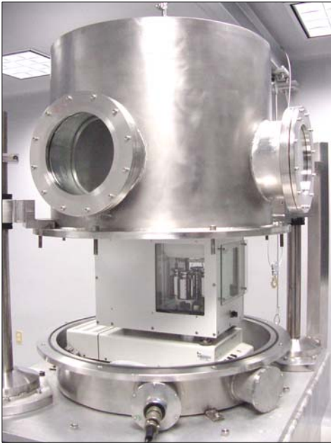
Figura 1.- Cámara Sellada para la Balanza Comparadora Marca Mettler, modelo HK1000MC. En la imagen se presenta abierta para mostrar la balanza.
